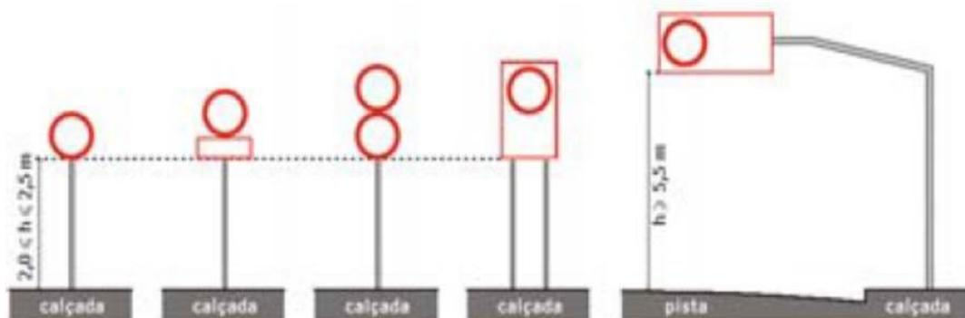
O afastamento lateral das placas, medido entre a borda lateral da mesma e da pista, deve ser, no mínimo, de 0,30 metros para trechos retos da via, e 0,40 metros nos trechos em curva.
